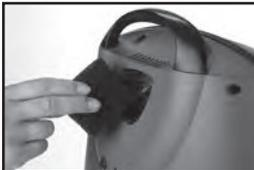
Tipps für die Reinigung: Halten Sie einen zweiten Filter vorrätig, der verwendet wird, während der erste Filter trocknet.
